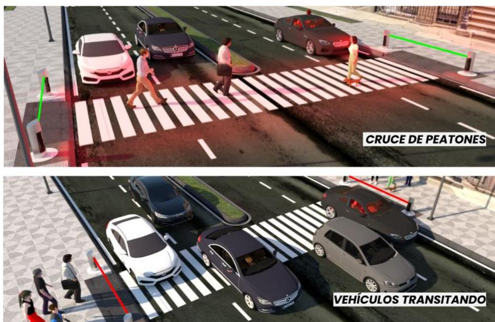
**Figura 8.** *Funcionamiento de semáforo peatonal.*
