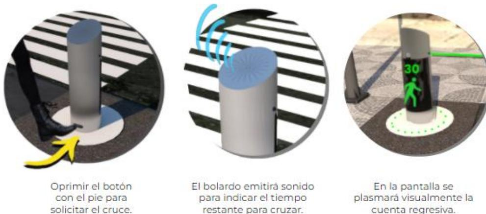
**Figura 7.** Ciclo de uso y detalles de semáforo peatonal.
